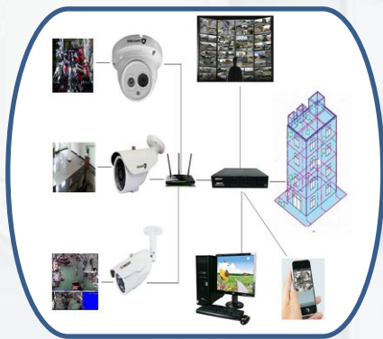
HỆ THỐNG CAMERA
